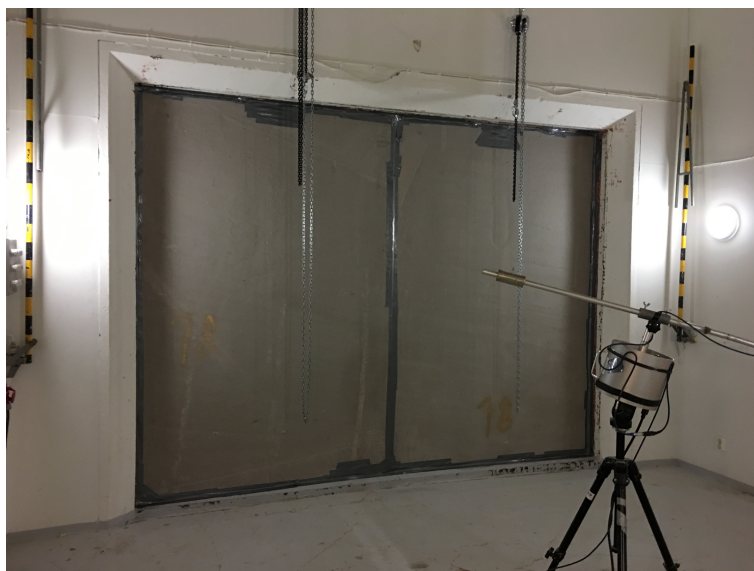
Foto 1.1 Skumbetong, 1800 \text{ kg/m}^3 och en medeltjocklek på 65 mm
