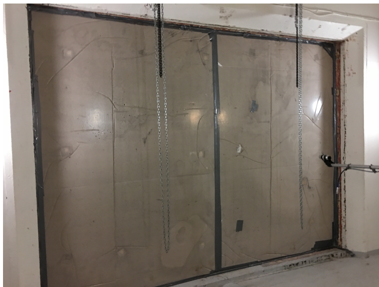
Foto 1.3 Skumbetong, 800 \text{ kg/m}^3 och en medeltjocklek på 65 mm
