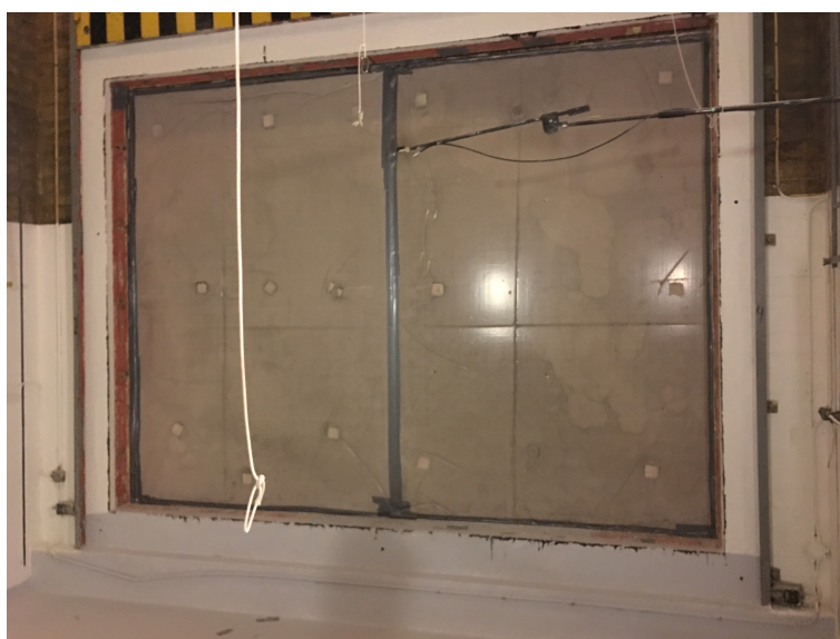
Foto 1.2 Skumbetong, 800 \text{ kg/m}^3 och en medeltjocklek på 125 mm
